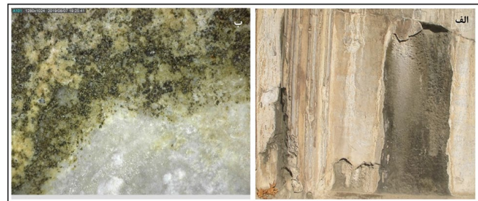
شکل ۱۱ الف- ناحیه دارای رسوب تیره در ضلع شمالی تاق بزرگ؛ ب- بزرگنمایی X۵۰ از نواحی سبزرنگ بر دیواره شمالی تاق بزرگ که رشد ارگانیزم را نشان می‌دهد
